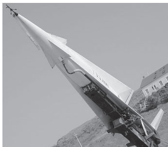
Nike Hercules era un missile di circa 12 m di lunghezza ed aveva una gittata massima di 110 Km. Era caricato con la testata nucleare W-31 di potenza pari a 2 kilotonnellate.
