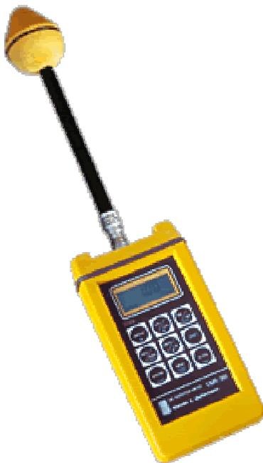
Il nostro strumento, non omologabile a quelli di tipo professionale decisamente più costosi, è stato tarato mediante comparazione di misure effettuate con il modello **EMR 20** della **Wankel e Goltermann** secondo le prescrizione del D.M. n. 381 del 10-09-98. Gli strumenti della serie EMR sono ad oggi un riferimento nella misura dei campi elettromagnetici ad alta frequenza.
