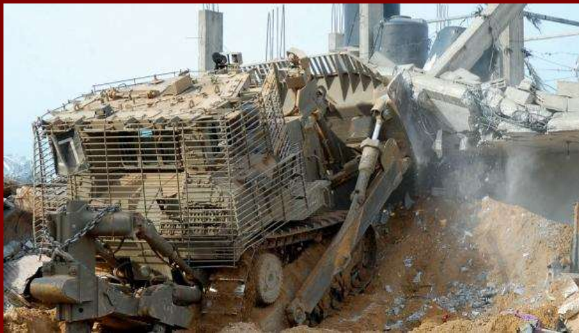
Una ruspa corazzata israeliana da 50 t in azione. Si notino gli aratri posteriori utilizzati per rompere le strade
